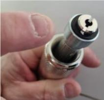
Passer le câble de sécurité autour du robinet de la bouteille puis connecter le raccord Co<sup>2</sup> en le vissant sens horaire au maximum à la main: **pas d'outil!**
