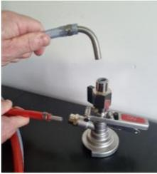
Connectez les têtes de débit : tuyaux rouge partie droite sur le côté de la tête , tuyau blanc partie coudée sur le haut de la tête.
